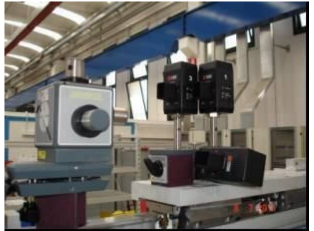
Allineamento guide rettezza planarità e rollio
